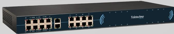
La TTB30-10 es una IP-PBX basada en software libre y potenciada con procesador Intel® Atom™ con manejo de varias combinaciones de puertos troncales y extensiones análogos. La PBX soporta 10 llamadas concurrentes con hasta 16 puertos análogos, hasta 8 puertos BRI ISDN, así como troncales y teléfonos IP con protocolo SIP e IAX2. La unidad esta acondicionada para ser montada en rack 19" y una altura de 1U, Teletechno Televoice Basic 30 usuarios 10 llamadas simultaneas máximo.
